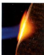
**Schmelzpunkt** erst bei  $> 1000^\circ\text{C}$  nach DIN 4102 Teil 17 (Prüfzeugnis 16 901 0434 000 lx vom FMPA Baden-Württemberg, Stuttgart)
